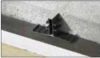
Schlüter-DILEX-EP ist ein Bewegungsfugenprofil für die Verarbeitung in schwimmenden oder Verbund-Estrichen. Die Seitenteile bestehen aus Hart-PVC mit einer unteren und oberen Bewegungszone aus grauem Weich-Kunststoff. (Produktdatenblatt 4.5)
