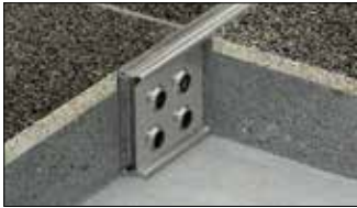
Schlüter-DILEX-EMP ist ein Bewegungsfugenprofil aus Edelstahl für die Mörtelbettverlegung, welches durch eine Nut- / Federverbindung horizontale Bewegungen aufnehmen kann. (Produktdatenblatt 4.17)
