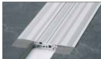
Schlüter-DILEX-BTS ist ein Bautrennfugenprofil aus Aluminium für den nachträglichen Einbau in fertige Belagsflächen. Durch die seitliche Gelenkanbindung des ineinander verschiebbaren Mittelteils ist eine dreidimensionale Bewegungsaufnahme möglich. (Produktdatenblatt 4.20)
