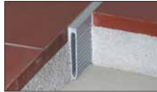
Schlüter-DILEX-MOP ist ein Dehnungsfugenprofil mit stabilen gezahnten Seitenwänden aus Hart-PVC-Regenerat und einer zwischen den Seitenwänden liegenden Dehnzone aus grauem Weich-Kunststoff für den Einbau bei Mörtelverlegung. (Produktdatenblatt 4.4)
