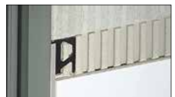
Schlüter-DILEX-BWA ist ein flexibles Anschlussprofil aus Kunststoff für Anschlussfugen von Fliesenbelägen zu bestehenden Belagsflächen oder Einbauteilen wie z. B. Türzargen und Fensterelementen. (Produktdatenblatt 4.9)
