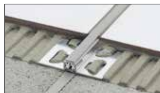
Schlüter-DILEX-AKWS ist ein Bewegungsprofil mit seitlichen Befestigungsschenkel aus Aluminium, die mit einer Bewegungszone aus weichem Kunststoff verbunden sind. (Produktdatenblatt 4.18)
