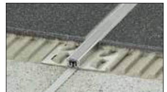
Schlüter-DILEX-KS ist ein Bewegungsprofil mit Kantenschutz, bestehend aus seitlichen Befestigungsschenkel aus Aluminium oder Edelstahl, die mit einer auswechselbaren Dehnzone aus weichem Kunststoff verbunden sind. (Produktdatenblatt 4.8)
