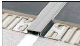
Schlüter-DILEX-KSBT ist ein Bautrennfugenprofil mit Kantenschutz, bestehend aus seitlichen Befestigungsschenkel aus Aluminium oder Edelstahl, die mit einer 20 oder 30 mm breiten Bewegungszone aus weichem Kunststoff verbunden sind. (Produktdatenblatt 4.19)
