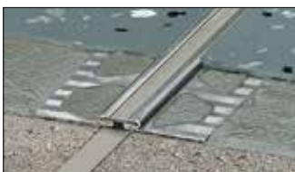
Schlüter-DILEX-EKSB ist ein Bewegungsprofil mit Kantenschutz für Beschichtungen und sonstige dünn-schichtige Bodenbeläge. Es besteht aus seitlichen Befestigungsschenkel aus Edelstahl, die mit einer nicht-auswechselbaren Dehnzone aus weichem Kunststoff verbunden sind. (Produktdatenblatt 4.8)
