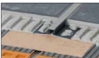
Schlüter-DILEX-BWB ist ein Bewegungsfugenprofil mit Seitenteilen aus Hart-PVC-Regenerat. Die obere Bewegungszone besteht aus weichem Kunststoff und bildet die 10 mm breite Sichtfläche. (Produktdatenblatt 4.6)
