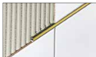
Schlüter-DILEX-EZ 6 und 9 sind spezielle Entspannungs- und Zierprofile zur dekorativen Gestaltung von Fugen mit zusätzlicher Entspannungsfunktion in Fliesen- und Natursteinbelägen, die im Dünnbett verlegt werden. (Produktdatenblatt 4.1)
