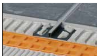
Schlüter-DILEX-BWS ist ein Bewegungsfugenprofil mit Seitenteilen aus Hart-PVC-Regenerat. Die Bewegungszone besteht aus weichem Kunststoff und bildet die 5 mm breite Sichtfläche. (Produktdatenblatt 4.7)
